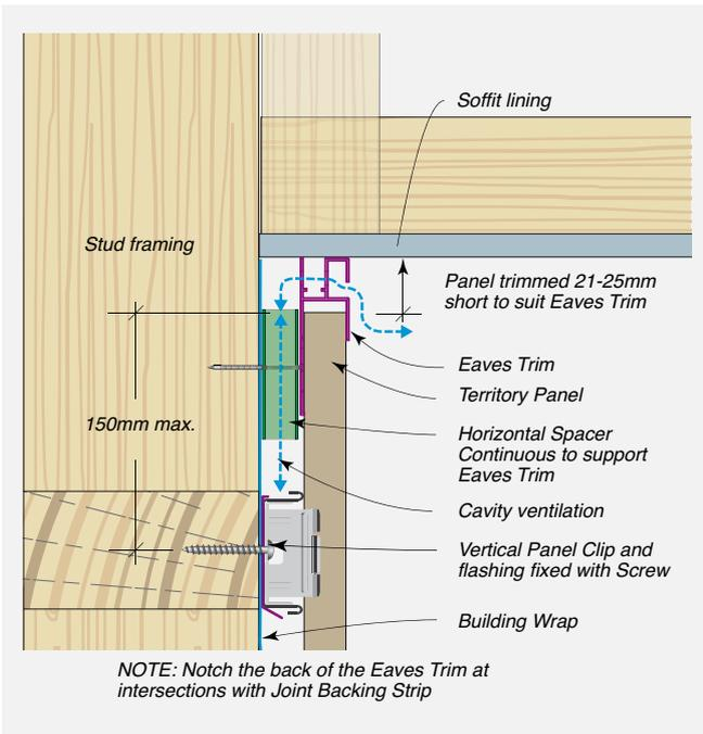
**FIGURE 8.07** Soffit Detail
